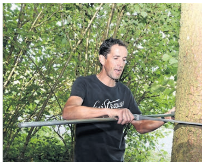
L'utilisation du pied à coulisse forestier permet à Serge Delessert de déterminer le diamètre du tronc
