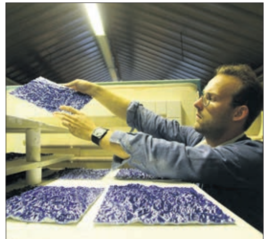
Alexandre Wolhoff au défournage des tuiles
